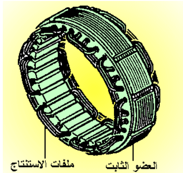
الشكل ( ٢ - ٤٨ ) يبين أجزاء العضو الثابت للمولد
