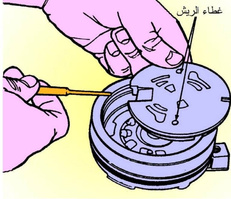
الشكل ( ٥ - ٣٢ ) يبين تركيب غطاء الريش داخل المجمع
