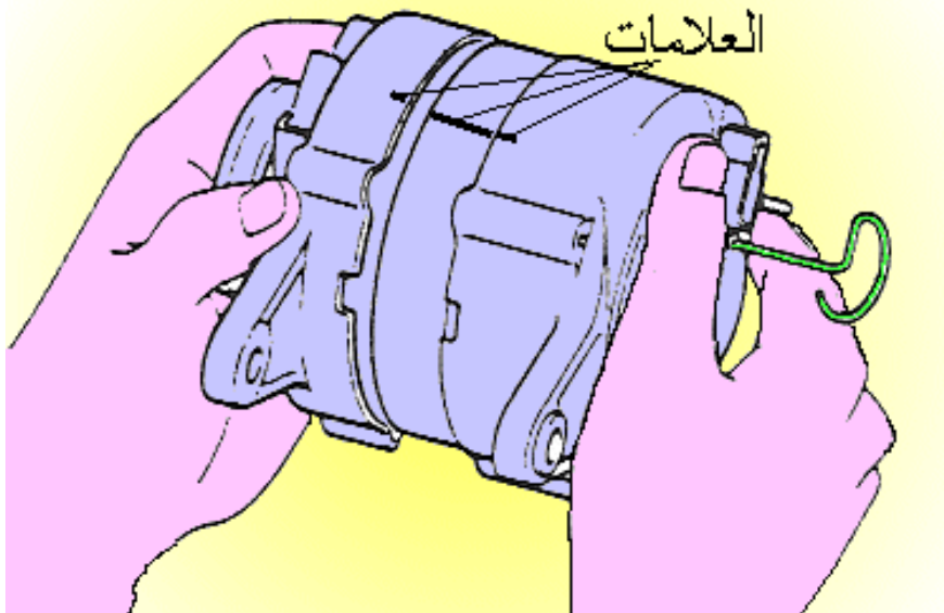
الشكل (1- 35) يبين تجميع المولد حسب العلامات
