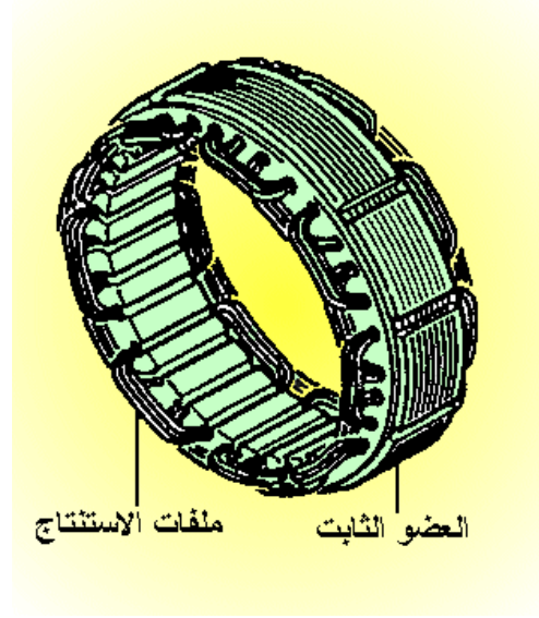
الشكل (1- 4) يبين أجزاء العضو الثابت للمولد
