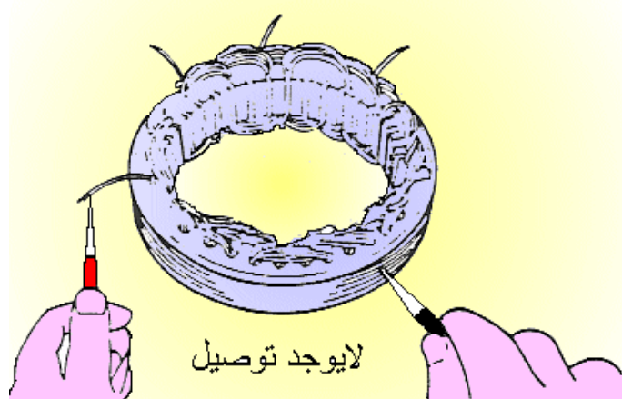
الشكل (1- 28) يبين فحص العضو الثابت بواسطة جهاز قياس المقاومة ( الأوميتر)
