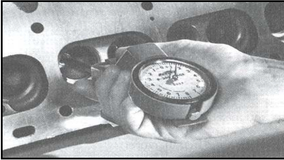
شكل (٢ - ٥٤) يبين قياس القطر الداخلي للدليل بجهاز قياس الأقطار الداخلية
