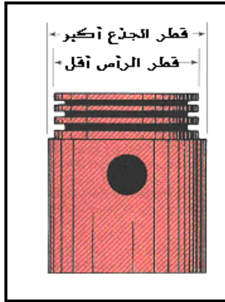
(شكل ٢ - ٤٣) يبين تصميم قطر الجذع والرأس للمكبس
