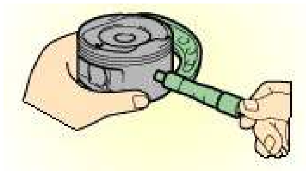
(شكل ٢- ٤١) يوضح كيفية قياس قطر المكبس
